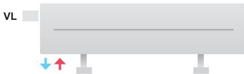
VL mit Thermostatventil links
