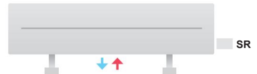
SR Mitte mit Thermostatventil
